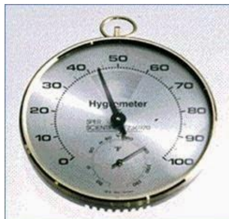
Figura 2: Higrômetro que utiliza cabelo humano como elemento sensível [5].
